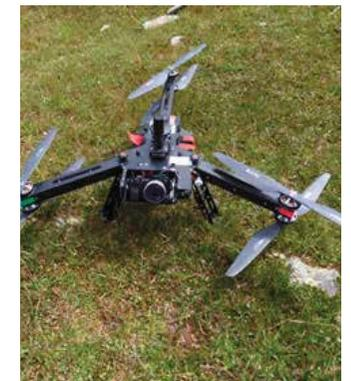
Luftbilddaufnahme am Tschadinhorn Blockgletscher mit der Drohne twinFold GEO, einem Y6 Hexacopter
