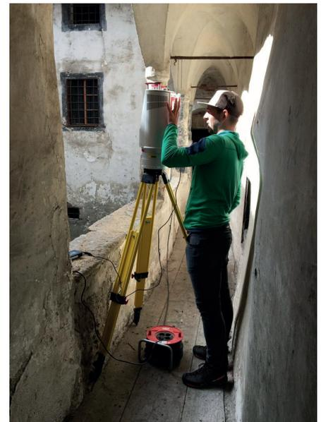
Abb. 16: Riegl-Scanner VZ6000 bei Aufnahmen im Innenhof
