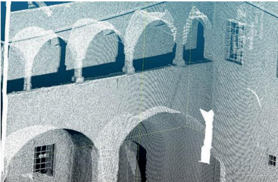
Abb. 15: Der Ausschnitt aus der TLS-Punktwolke zeigt die Arkaden im 1. Obergeschoß der W-Ecke des Schlosshofes; Beachte die hohe Detailtreue bei der Erfassung der Fenstergitter
