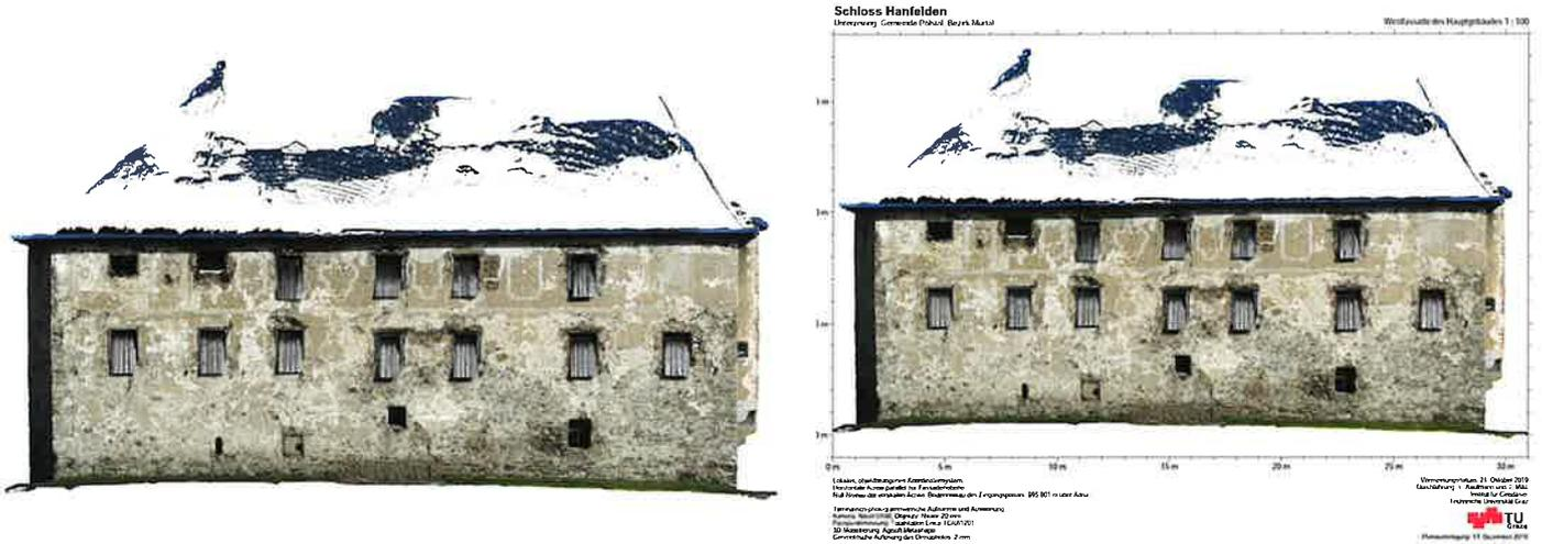
Abb. 39: Orthophoto mit einer Auflösung von 2mm (links) und ein Orthophotoplan (1:100) der Westfassade (Sulzer et al. 2021).
