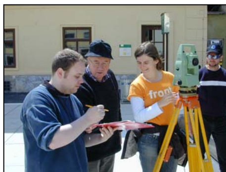
Geodätische Einmessung von Objekt- und Passpunkten
