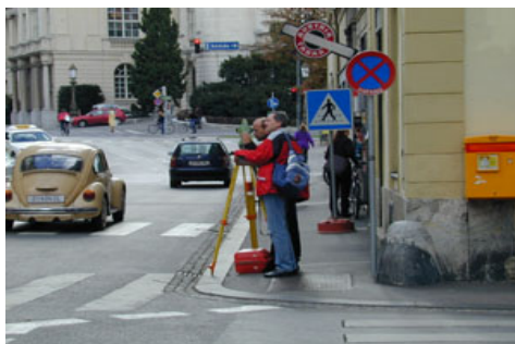
Geodätische Vermessung mit Totalstation
