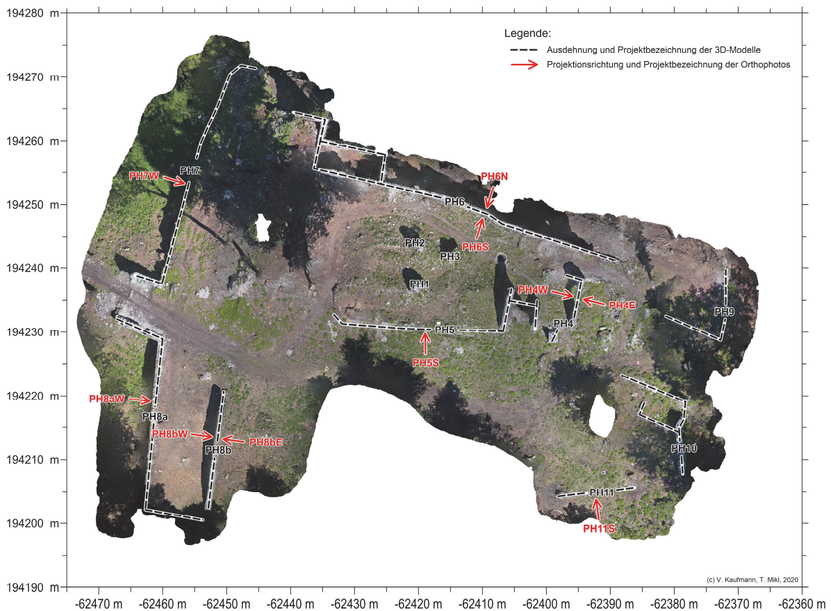
Abbildung 2: Lageplan der texturierten 3D-Modelle und Orthophotos. Landekoordinatensystem (MGI (Ferro) / Austria GK East Zone; EPSG: 31253). Orthophoto abgeleitet aus der UAV-Befliegung.
