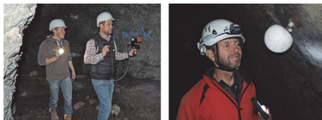
Abb. 5: Terrestrisches Laserscanning mit dem System GeoSLAM ZEB-REVO (links); Signalisierung mit einer Kugelkalotte aus Styropor (rechts). Photos: V. Kaufmann, 24.10.2017.
