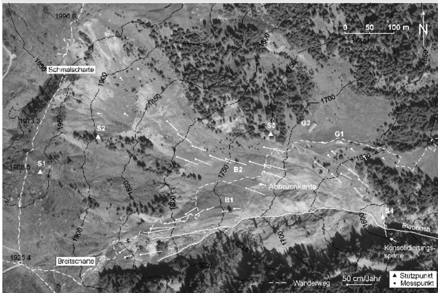
Abb. 4: Orthofotokarte mit Darstellung der mittleren jährlichen Horizontalbewegung der 41 Beobachtungspunkte des Rutschhanges Blaubachgraben für den Beobachtungszeitraum September 2004-2005. Die maximale Bewegungsrate beträgt 50 cm/Jahr. Die geodätische Beobachtung des Punktes im Nahbereich des Gebäudes G1 ergab eine Kriechrate von 6 cm/Jahr. Man beachte den doppelten Maßstab der Bewegungsvektoren im Vergleich zur Abb. 3. Das Luftbild wurde am 6. September 2004 aufgenommen. Luftbild: © BEV-2005.
