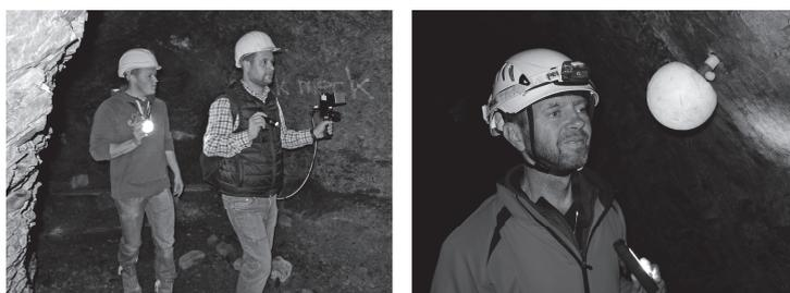
**Abb. 4:** Terrestrisches Laserscanning mit dem System GeoSLAM ZEB-REVO (links); Signalisierung mit einer Kugelkalotte aus Styropor (rechts). Photos: V. Kaufmann, 24.10.2017.
