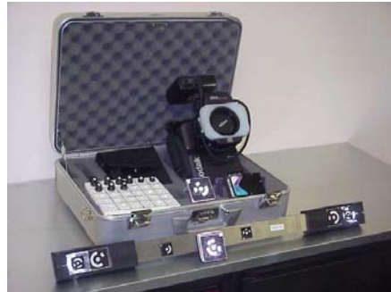
TRITOP-Messsystem der Firma GOM (Aufnahme Wiggenhagen, 2006)
