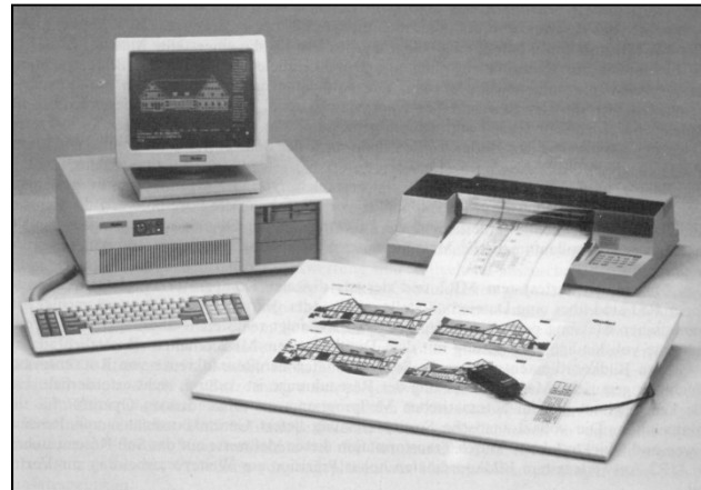
Hardwarekomponenten des Mehrbildauswertesystems Rolleimetric MR2. Steuerrechner, Digitizer zur Bildkoordinatenmessung und Plotter zur graphischen Ausgabe.
