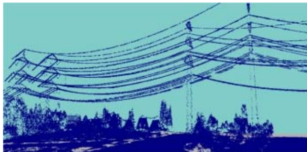
3D-Ansicht der Punktwolke im Leitungskorridor
