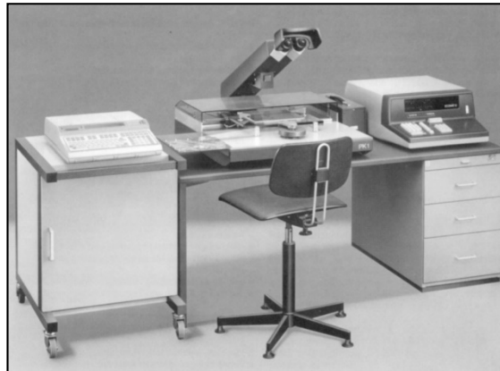
← Monokomparator Zeiss PK-1 mit automatischer Datenregistrierung, interne Messgenauigkeit: 1 \mu\text{m} .
