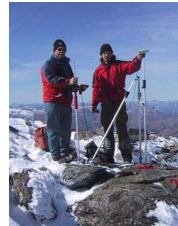
Bestimmung des Passpunktes "Weisseespitze" mittels GPS.
